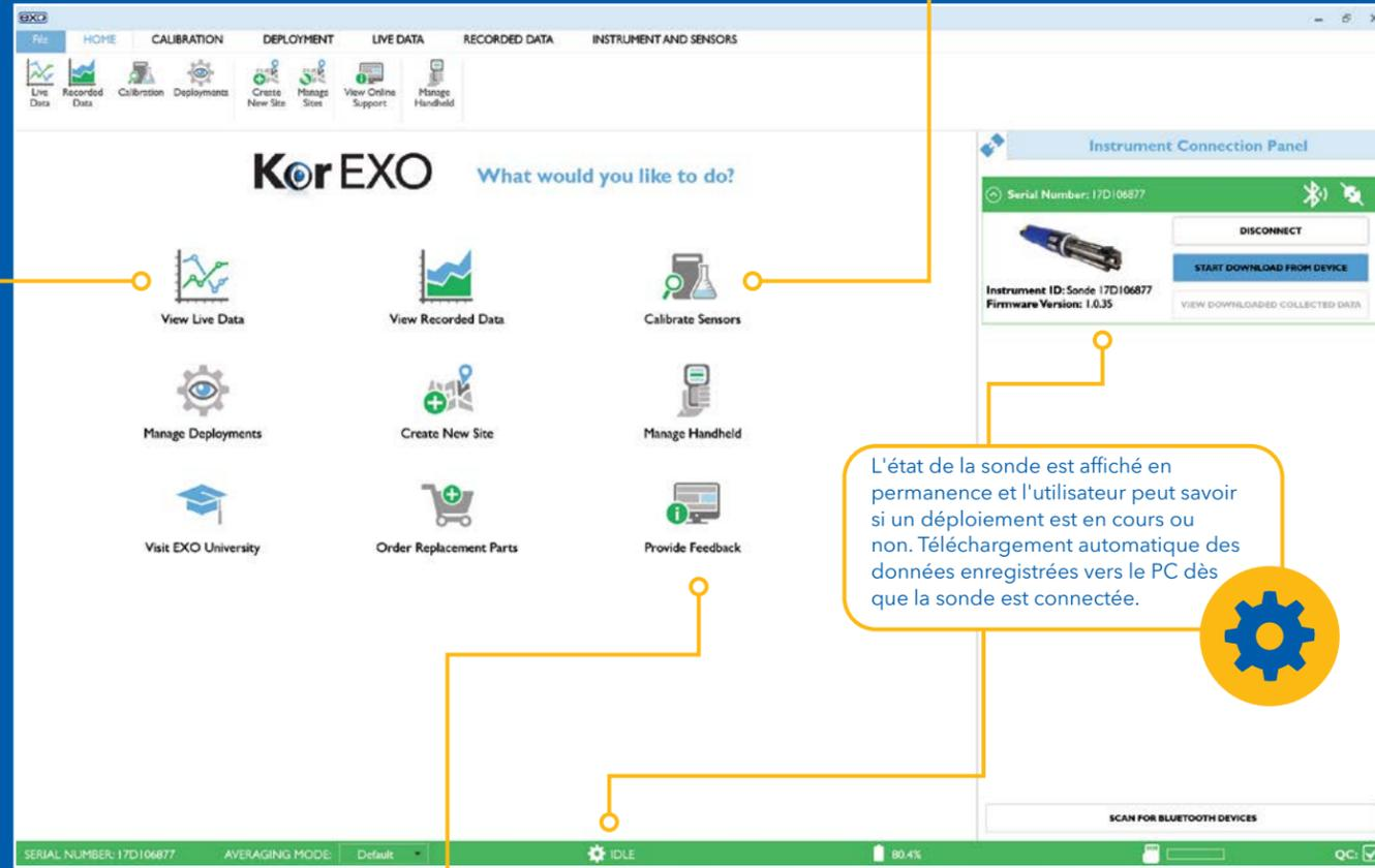
L'état de la sonde est affiché en permanence et l'utilisateur peut savoir si un déploiement est en cours ou non. Téléchargement automatique des données enregistrées vers le PC dès que la sonde est connectée.
