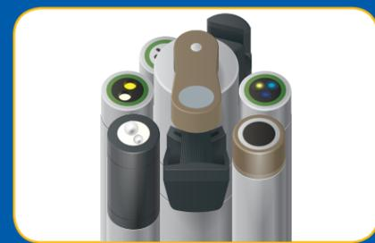
Le balai anti-encrassement nettoie la surface des capteurs, réduisant la maintenance et optimisant la durée de déploiement.
